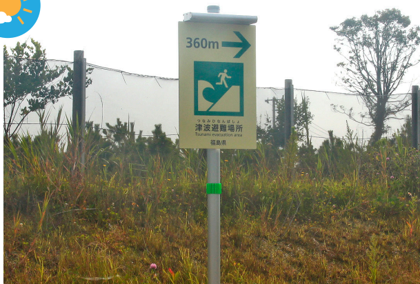
避難誘導標識（小） 表示板サイズ：W400×H600 表示方法：スーパーカラー R 本体素材：アルミ押出型材、ソーラー LED ライト
